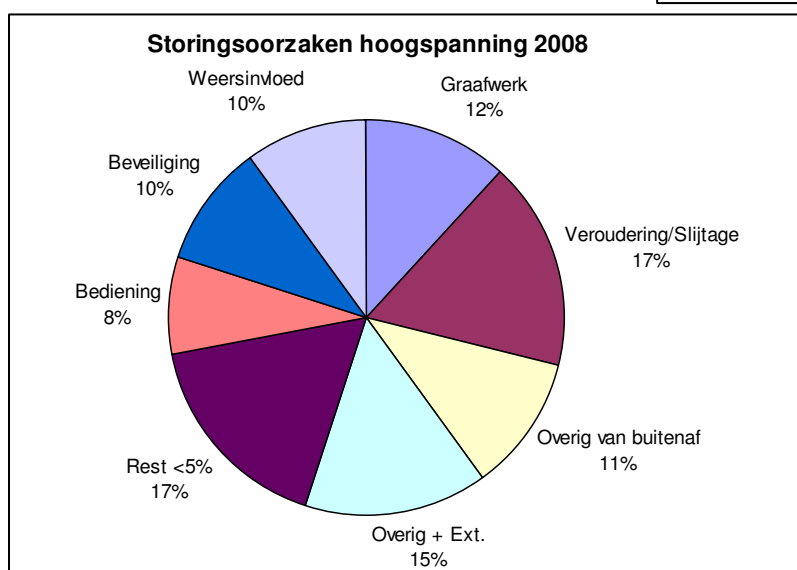
Figuur 3.3: Storingsoorzaken voor Laag-, Midden- en Hoogspanning in Nederland in 2008
